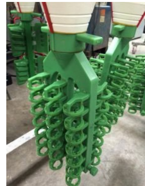
Gauche: exemples de pièces coulées en sable. Droite: grappe de modèles en cire perdue.
